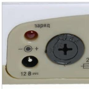
Разъем подключения источника постоянного тока 12 В (для ДБА 3926).
