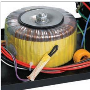
Наличие термозащиты обеспечивает отключение нагрузки при повышении температуры автотрансформатора.
