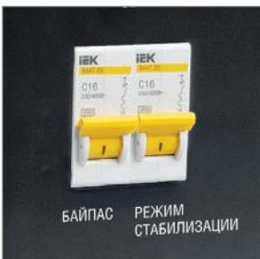
Для типоразмеров 3, 5, 8, 10 кВА, подключаемых через клеммную коробку, предусмотрена функция «байпас», при включении которой напряжение на входе стабилизатора передается на нагрузку без стабилизации.
