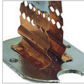
Плавкий элемент выполнен из фосфористой бронзы (сплав меди с цинком с добавлением фосфора) и надежно соединен точечной сваркой с выводами предохранителя.
