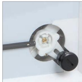
Приборы оснащены механическим устройством корректировки нулевого положения стрелки.
