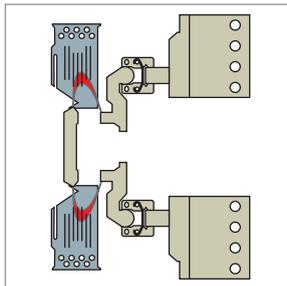
Система двойного разрыва Double Break гарантирует быстрый разрыв дуги токов КЗ за счет разделения дуги пополам с помощью размыкания в двух точках каждого полюса. В результате уменьшается износ контактов и снижается их эрозия.
