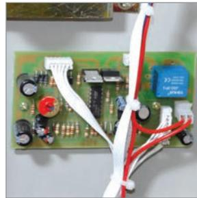
В стабилизаторах напряжения СНИЗ реализована функция защиты от потери фазы, которая при возникновении данной аварийной ситуации отключает стабилизатор. Данная защита особенно важна при питании электродвигателей (холодильники, кондиционеры и др.), которые при потере фазы выходят из строя.
