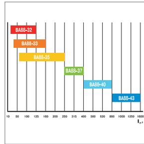
Полный диапазон тепловых расцепителей дает возможность обеспечить селективность при многоступенчатой системе защиты.
