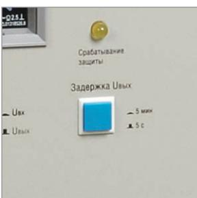
Наличие короткой и длительной задержки включения для защиты аппаратуры от бросков напряжения (холодильников, кондиционеров и т.п.).
