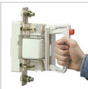
Все габариты плавких вставок ППНИ удобно устанавливать или демонтировать универсальной рукояткой съема РС-1, изоляция которой выдерживает напряжение до 1000 В.
