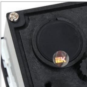
Пломбировка корпуса предотвращает несанкционированный доступ к механизму измерения прибора.
