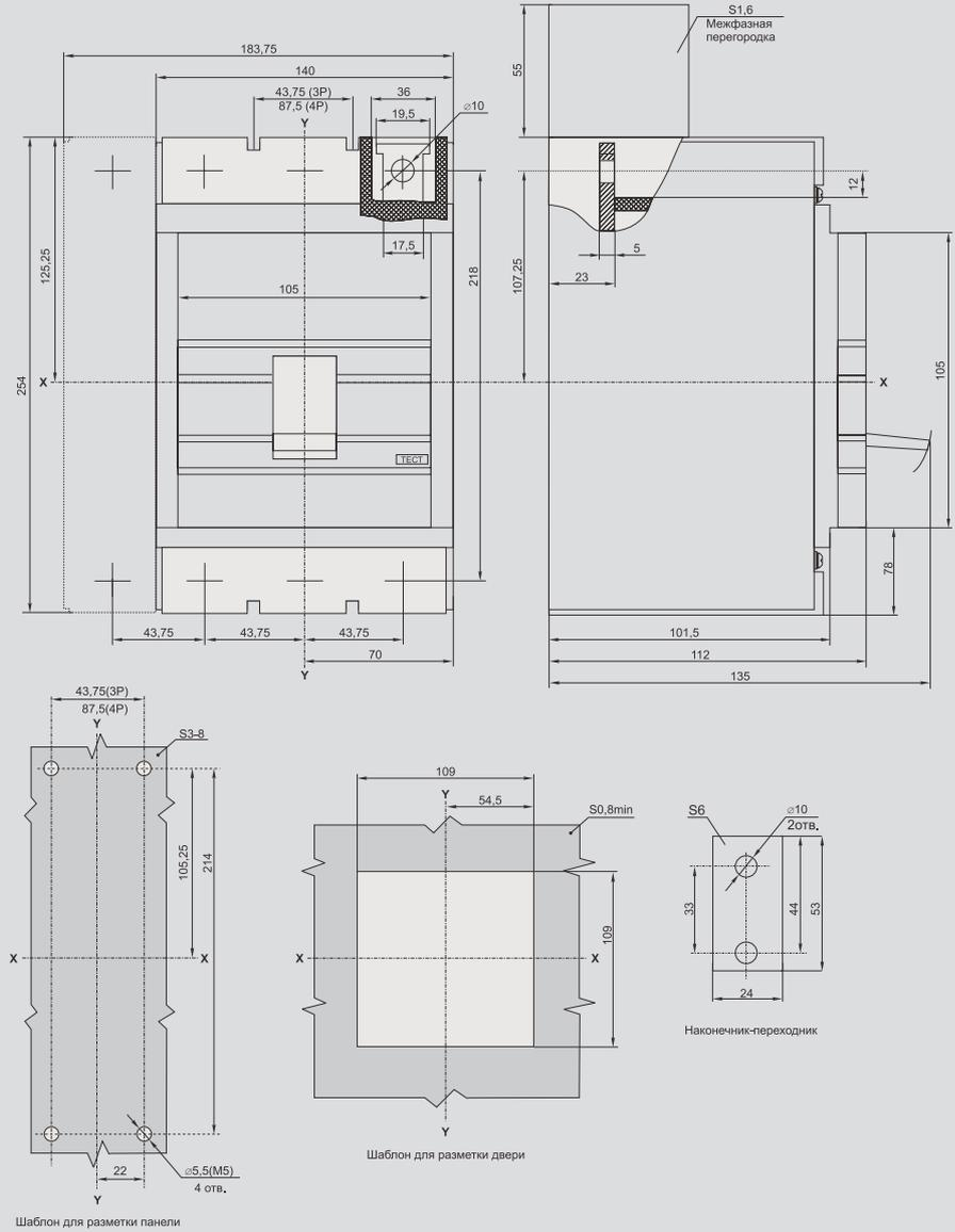
ВА88-37 с ручным поворотным приводом ПРП-37
