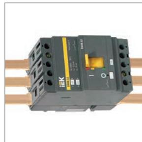
Выключатели BA88 могут устанавливаться в любом положении без изменений их номинальных характеристик. Выключатели BA88 могут запитываться через верхние или нижние клеммы без нарушения работоспособности.
