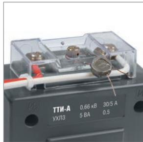
Крышку, закрывающую клеммные зажимы, можно опломбировать. Это особенно важно в схемах учета электроэнергии, так как позволяет исключить несанкционированный доступ к клеммным зажимам вторичной обмотки.
