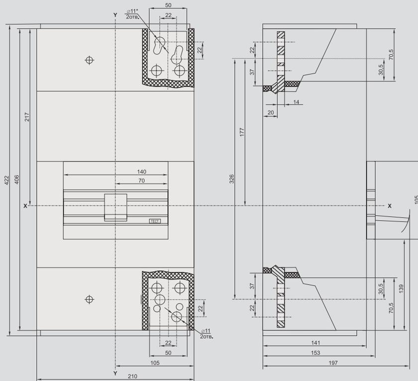
\*Отверстия предназначены для крепления наконечника-переходника
