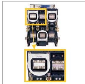
Использование двух трансформаторов на каждом полюсе. Первый трансформатор – линейный, отвечающий за контроль текущего сигнала. Он обеспечивает высокий класс точности во всем диапазоне токов КЗ. Второй трансформатор предназначен для питания электронного расцепителя.
