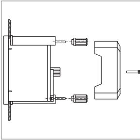
Монтажные элементы: гайки, винты крепления, пластиковые фиксаторы на панель щита, входящие в комплект поставки приборов, обеспечивают легкий монтаж без применения дополнительных элементов.
