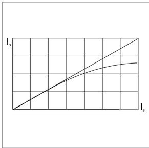
Токоограничение, то есть фактический ток во время короткого замыкания, гораздо ниже расчетного. Это реализовано за счет увеличенной скорости разрыва контактов, динамическое действие магнитного поля и структура дугогасящей камеры способствуют гашению дуги в кратчайшее возможное время.
