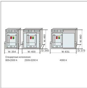
Все типоразмеры аппаратов с номинальным током до 3200 А имеют одинаковую глубину 345 мм и высоту 460 мм. Размер отверстия в панели щита под лицевую панель одинаков для всех выключателей серии ВА07, что облегчает монтаж в распределительной ячейке.
