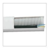
Двойной замок обеспечивает плотное соединение крышки кабель-канала с основанием, что позволяет укладывать внутри кабель-канала жесткие предметы (например, гофротрубу), а также производить монтаж кабель-канала на потолке.
