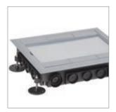
Наличие крышки напольной коробки защитит от попадания бетона при заливке. Регулировка высоты напольной коробки при монтаже может достигаться как за счет наличия регулировочных винтов (до 95 мм), так и за счет нивелирующего комплекта.
