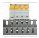
Шаг перфорации совпадает с шагом контактных зажимов на модульной аппаратуре, что исключает наложение клеммы на зубец канала. Благодаря этому время монтажа сокращается.
