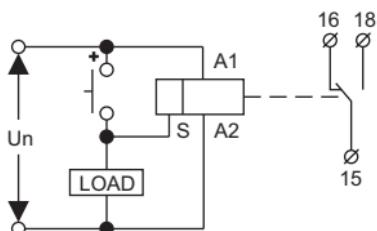
Рисунок 3 – Возможность подключения нагрузки к контактам S-A2
