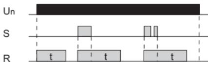
Рисунок 5 – Функциональная диаграмма реле задержки выключения
