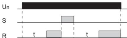
Рисунок 4 – Функциональная диаграмма реле задержки включения
