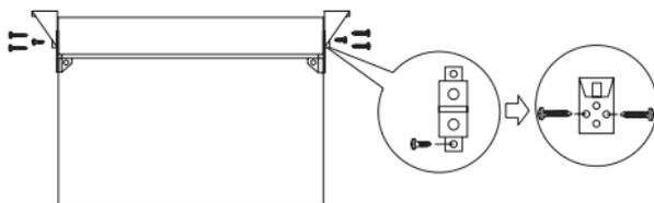
Рисунок 5 – Монтаж на потолок
