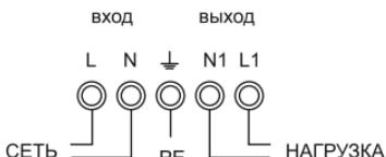
Рисунок 7. Схема подключения стабилизаторов от 3 до 10 кВА.
