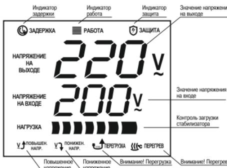
Рисунок 5. Индикация режимов работы переносных стабилизаторов.
