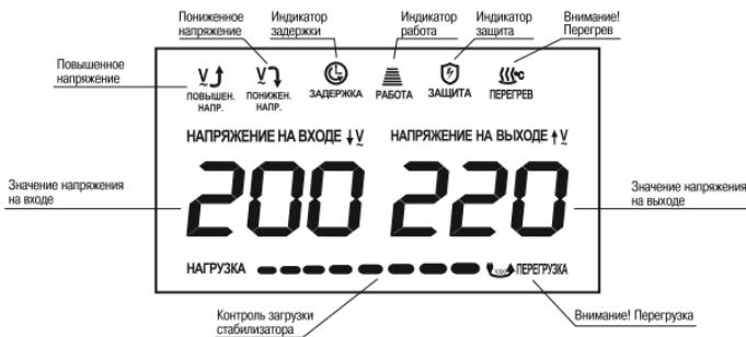
Рисунок 6. Индикация режимов работы на дисплее настенных стабилизаторов.
