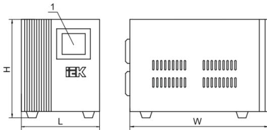
Рисунок 2. Переносной стабилизатор, вид спереди и сбоку.
