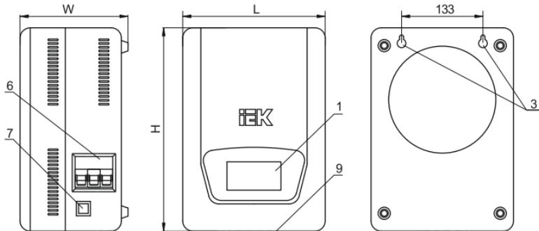
Рисунок 4. Настенный стабилизатор, вид сбоку, спереди и сзади .
