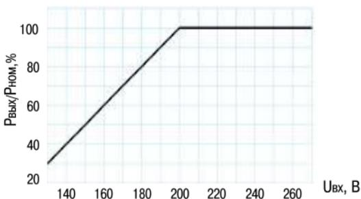
Рисунок 1 – Зависимость выходной мощности от входного напряжения
