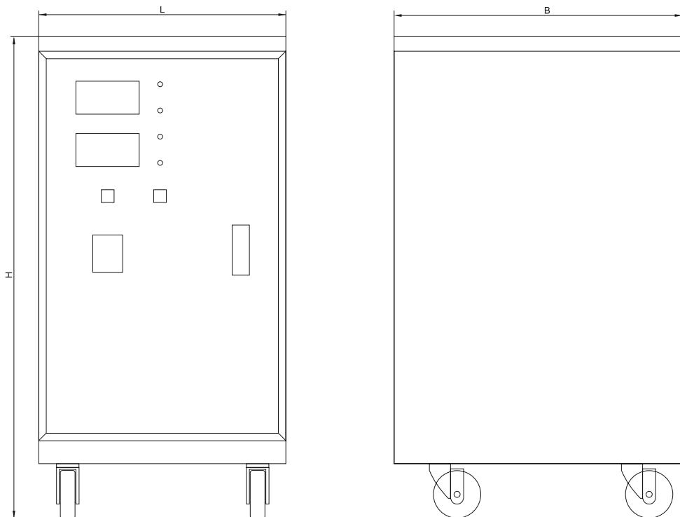
Рисунок 2 – Габаритные размеры CHI1 от 15 до 30 кВА
