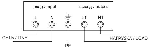
Рисунок 6 – Схема подключения СНИ1 от 2 до 10 кВА
