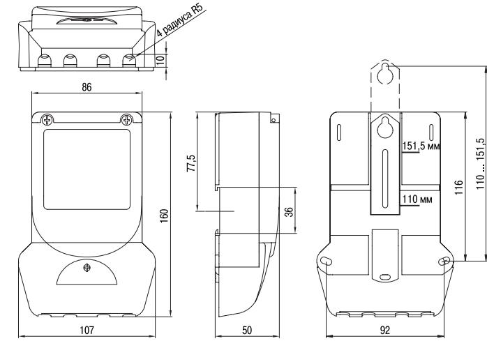
Рисунок 3 – Габаритные и присоединительные размеры счетчиков габарита 3
