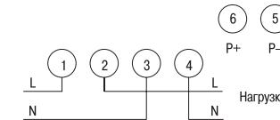
Рисунок 2 – Схема подключения счетчиков габарита 1
