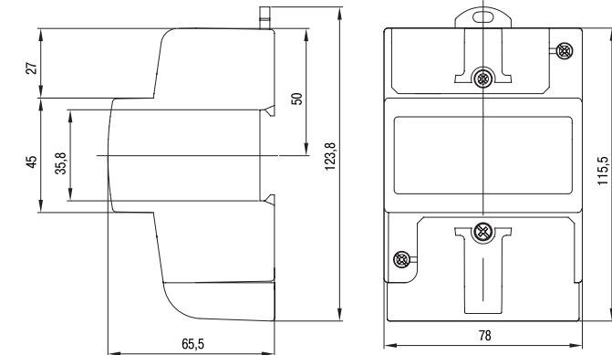
Рисунок 1 – Габаритные и присоединительные размеры счетчиков габарита 1
