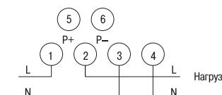
Рисунок 4 – Схема подключения счетчиков габарита 3
