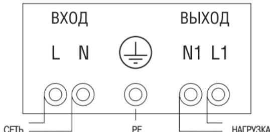
Рисунок 5. Схема подключения стабилизаторов.
