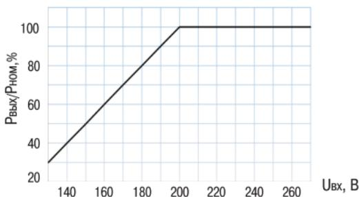
Рисунок 1. Зависимость выходной мощности от входного напряжения, где:
