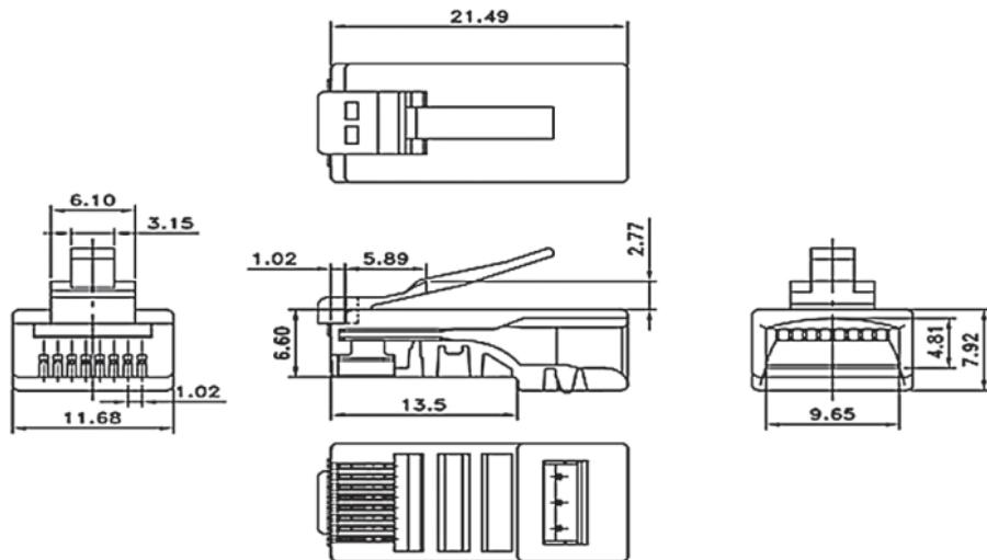
Рисунок 1 – Конструкция и размеры разъёма CS3-1C5EU-G
