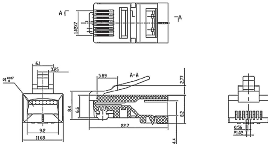
Рисунок 2 – Конструкция и размеры разъёма CS3-1C5EF-G
