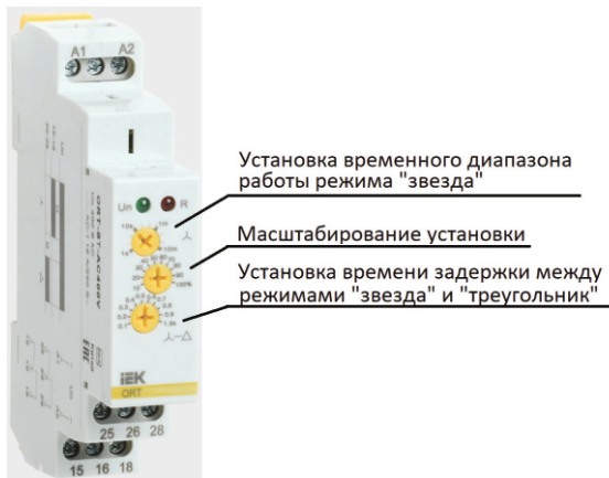
Рисунок 5 – Назначение органов управления реле
