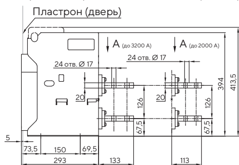
Вид сбоку Вариант 1. Горизонтальные выводы (стандарт)
