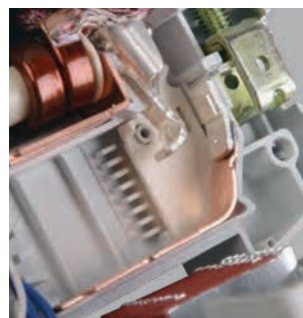
Напайка из серебросодержащего композита повышает износостойкость контактной группы и снижает переходное сопротивление.
