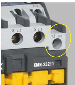
Наличие встроенных дополнительных контактов. Каждый контактор до 32 А комплектуется одним встроенным дополнительным контактом: 1НО или 1НЗ (закрывающий или размыкающий). Контактors от 40 до 95 А комплектуются двумя дополнительными контактами: 1НО + 1НЗ.
