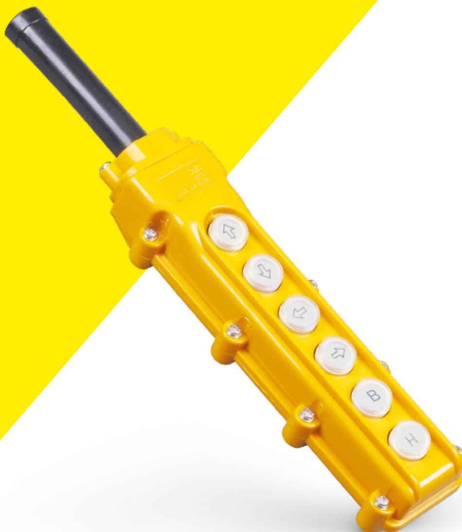
Предназначены для коммутации электрических цепей управления подъемными механизмами. Представляют собой герметичный корпус из термостойкой ABS-пластмассы с установленными кнопками. Для герметизации ввода кабеля предусмотрен защитный сальник, а между корпусом и панелью устанавливается герметизирующая прокладка.
