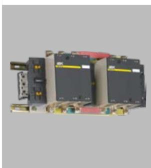
Собранный на заводе реверсивный контактор поставляется с заводскими шинами и механической блокировкой. Контактные группы КТИ смонтированы на двух металлических рейках, что обеспечивает высокую жесткость конструкции. Реверсивные контакторы КТИ представляют собой отдельную группу в ассортименте компании.
