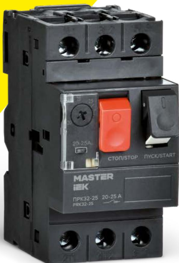
Предназначены для промышленного использования в качестве комплектующих изделий в схемах управления электроприводами, применяются для защиты трехфазных асинхронных электродвигателей, а также контакторов, управляющих ими, от токов перегрузки недопустимой продолжительности и токов короткого замыкания, неполнофазных режимов работы и для дистанционного пуска и остановки.
