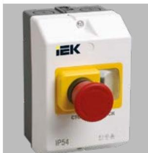
Защитная оболочка с поворотной-нажимной кнопкой «Стоп» и прозрачным защитным протектором под кнопку «Пуск», обеспечивающая степень защиты IP54 по ГОСТ 14254 (IEC 60529).
