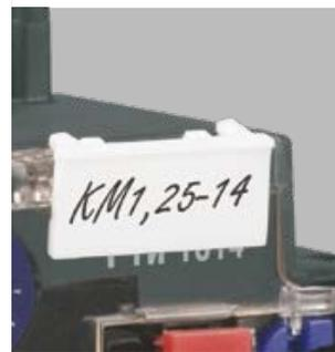
Поверхность для нанесения маркировки позволяет делать указание на соответствие схеме, что упрощает монтаж.
