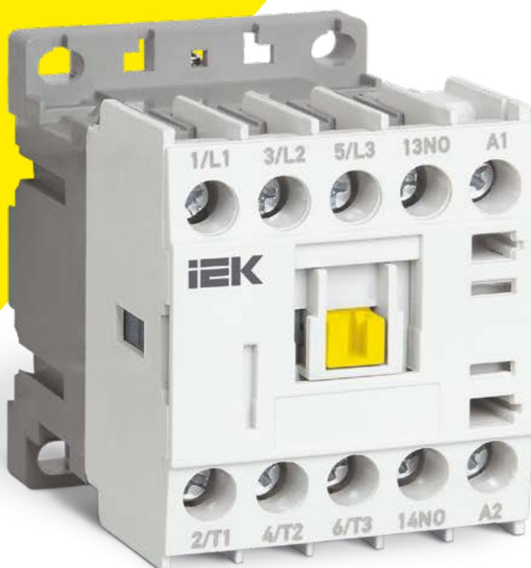
Предназначены для использования в схемах управления различных нагрузок на напряжение переменного тока до 660 В частоты 50 Гц. Позволяют дистанционно коммутировать силовые электрические сети в категориях применения AC-3 (управление электродвигателями мощностью до 5 кВт), и AC-1 (управление нагревательными приборами). Степень защиты, обеспечиваемая оболочкой миниконтакторов, – IP20 по ГОСТ 14254 (IEC 60529). Климатическое исполнение и категория применения контакторов – УХЛ4 по ГОСТ 15150.
