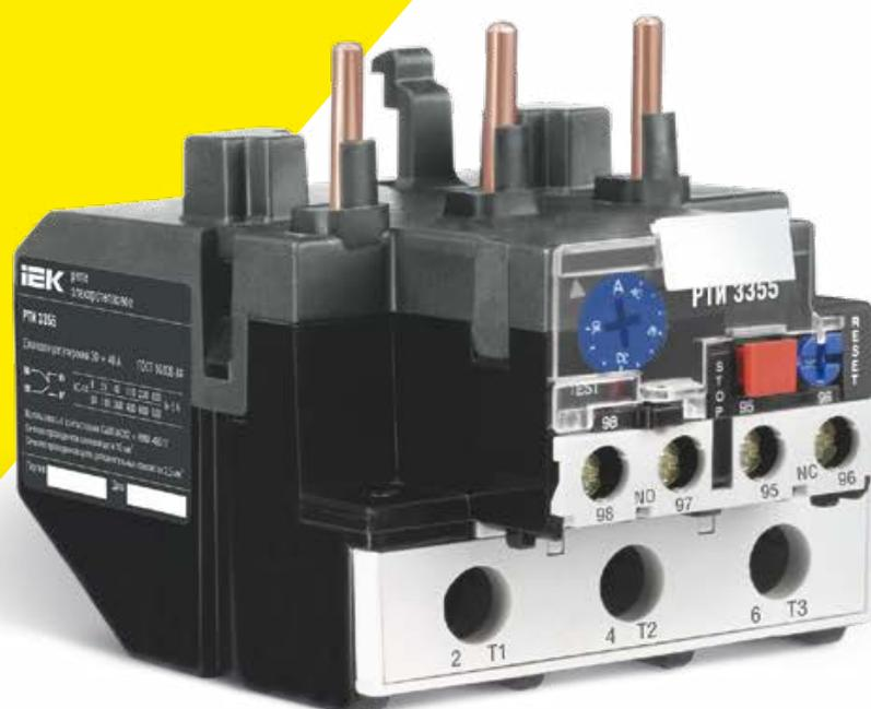
Предназначены для защиты электродвигателей от перегрузки, асимметрии фаз, затынутого пуска и заклинивания ротора. Устанавливаются непосредственно на контакторах КМИ. Для защиты от короткого замыкания должны быть предусмотрены предохранители или автоматические выключатели на соответствующее значение номинального тока срабатывания.
