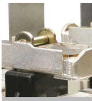
На контакт-детали нанесено серебряное покрытие, позволяющее использовать контакторы в продолжительном режиме работы. Напайки на контакт-детали выполнены из композитов на основе серебра, что позволяет уменьшить контактное сопротивление при повышении температуры.
