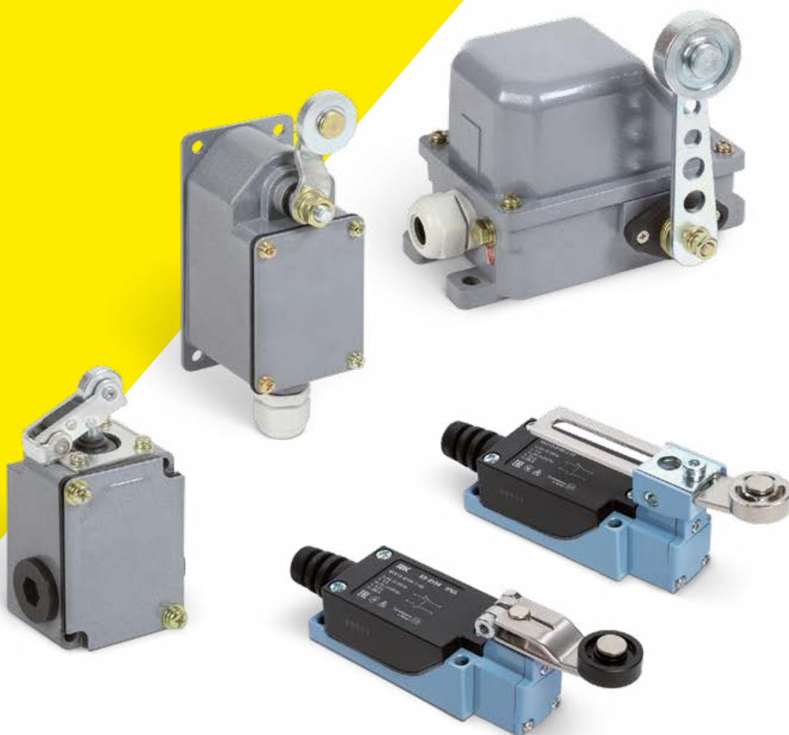
Предназначены для коммутации электрических цепей управления переменного и постоянного тока под воздействием управляющих упоров в определенных точках пути контролируемого объекта. Выключатели выполнены в соответствии с требованиями ГОСТ 30011.5.1.
