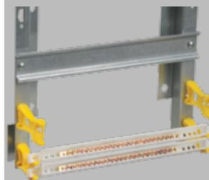
Шины N и PE защелкиваются в держатели стоек, которые устанавливаются в гнезда монтажных профилей при помощи зацепов. Удобный подвод кабеля.
