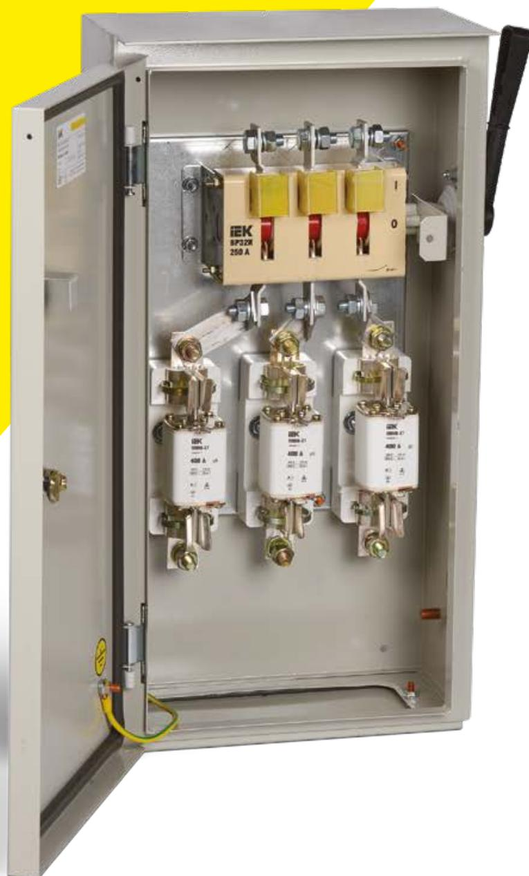
Предназначены для нечастых коммутаций и защиты от токов короткого замыкания в цепях трехфазного переменного тока напряжением 400/230 В частотой 50 Гц. Внутри корпуса установлены выключатель-разъединитель ВР-32И, три держателя предохранителей ДП-33 с предохранителем ППНИ. Ввод и вывод кабелей предусматривается снизу.
