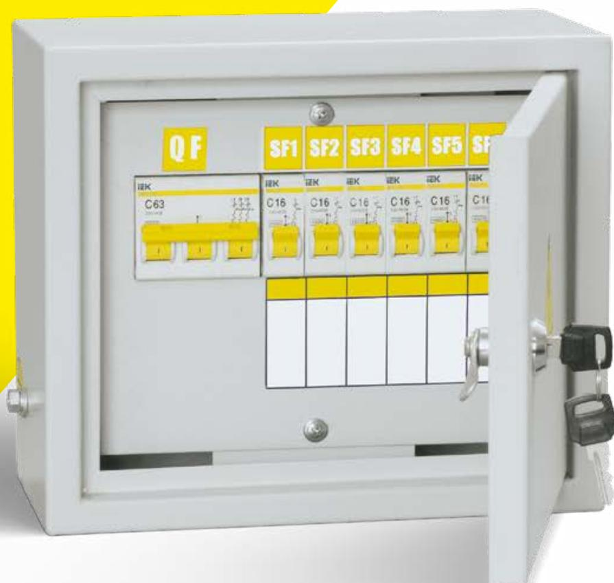
Предназначены для приема и распределения электроэнергии в жилых и производственных помещениях, а также для защиты линий при перегрузках и токах короткого замыкания в сетях переменного тока напряжением 230/400 В.
