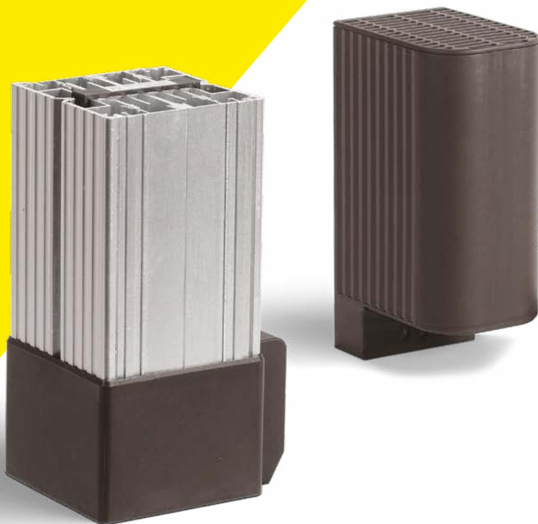
Предназначены для нагрева воздуха внутри электротехнических шкафов. Создаваемый ими конвекционный воздушный поток предотвращает образование областей с низкой температурой и защищает электрические компоненты от образования конденсата и замерзания при перепадах температуры, а также от коррозии металлических элементов активного оборудования.
