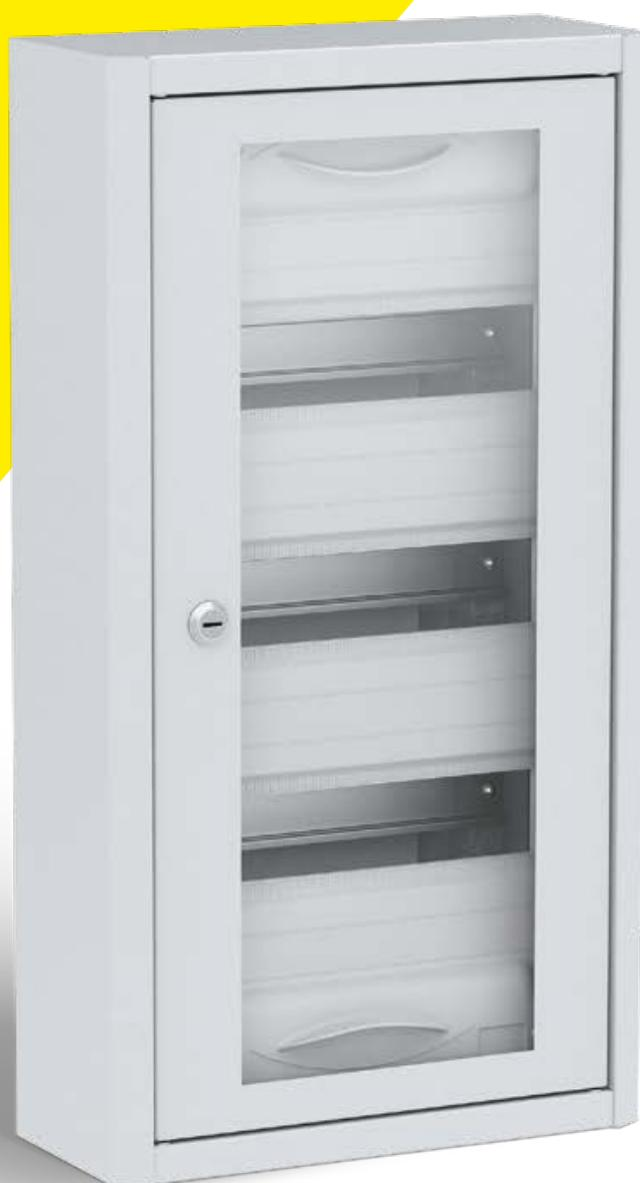
Корпуса распределительные ЩРН с прозрачной дверью TITAN 5 предназначены для сборки распределительных электрощитов с использованием модульной аппаратуры, для ввода и распределения электроэнергии, а также для защиты сетей с напряжением 230/400 В от токов перегрузки и короткого замыкания.
