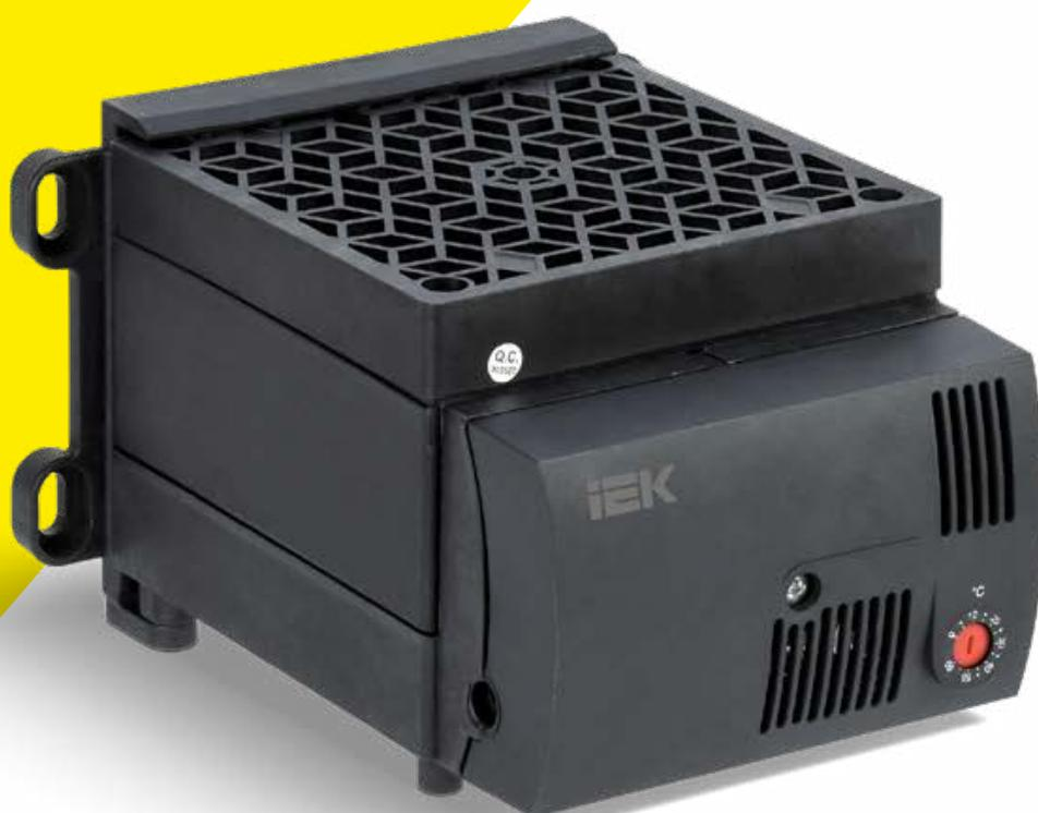
Мощные обогреватели защищают электрические компоненты от образования конденсата и замерзания при перепадах температуры, а также предохраняют от коррозии металлические элементы активного оборудования. Наличие калорифера с саморегулированием позволяет избежать перегрева. Легко монтируются на DIN-рейку или монтажную панель.
