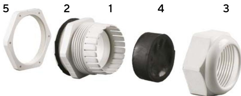
Сальник состоит из корпуса (1), уплотнителя (4), гайки уплотнения (3), прокладки (2) и фиксирующей гайки (5). Уплотнитель и прокладка выполнены из каучука.
