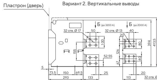
Вид сбоку Вариант 2. Вертикальные выводы
