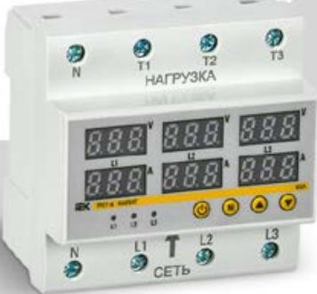
Используется для автоматического выключения питания при выходе напряжения или тока за допустимые пределы. Электронная плата анализирует параметры и выводит их на дисплей. Пределы можно регулировать самостоятельно с помощью кнопочного меню.
