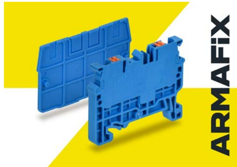
Клеммные колодки синего цвета на диапазон сечений проводников от 1,5 до 10 мм<sup>2</sup> используются для коммутации проводников нейтрали и являются неотъемлемой частью модельного ряда клемм, устанавливаемых на DIN-рейку. Торцевые заглушки предназначены для закрытия токоведущих частей при завершении клеммного ряда.
