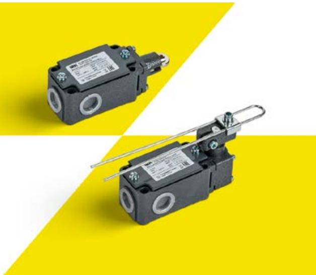
Предназначены для коммутации электрических цепей управления переменного и постоянного тока под воздействием управляющих упоров в определенных точках пути контролируемого объекта. Срабатывают при достижении механизмами заданных точек, размыкая или переключая электрические цепи управления.
