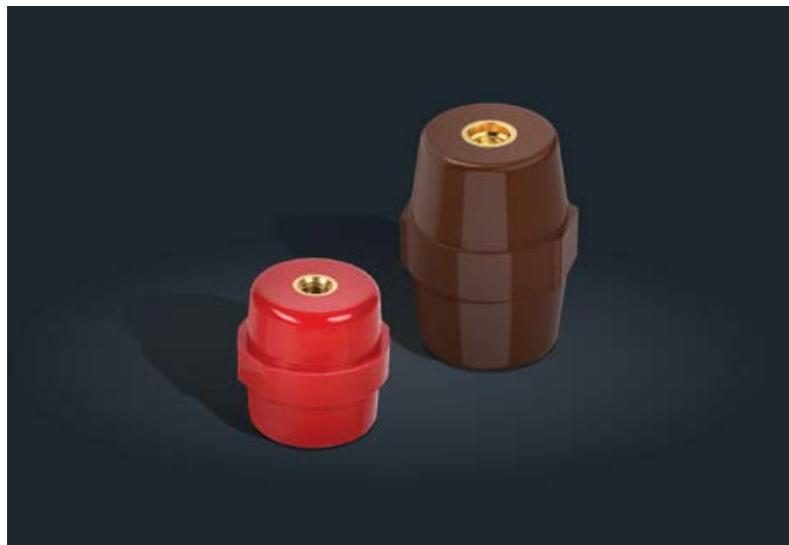
Предназначены для изоляции и крепления токоведущих частей НКУ. Изготавливаются из полимера по новой технологии эпоксидного формования. Монолитная заливка изделий под давлением исключает появление усадочных раковин.
