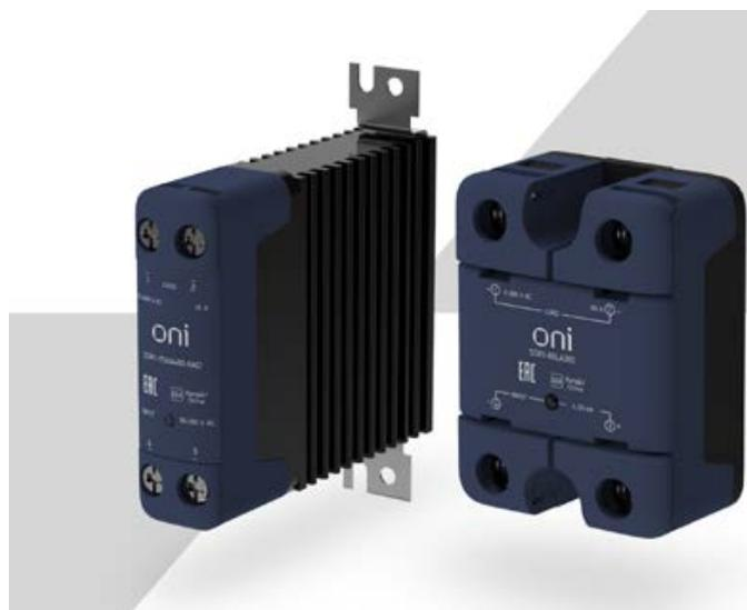
Предназначены для коммутации однофазных нагрузок высокой мощности (а также трехфазных при подключении «звездой» либо «треугольником») в цепях переменного и постоянного тока. Быстрое и бесшумное срабатывание позволяет использовать реле в узлах, где это является важным критерием работы (например, при управлении ТЭНами для поддержания температуры).
