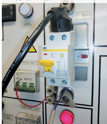
Выключение нагрузки происходит при напряжении 275 В, как и заявлено. При этом индикатор мигает красным цветом. При понижении напряжения включение происходит примерно при 270 В. Точнее, мигающий индикатор становится зеленым, а это говорит о том, что можно подавать питание на нагрузку. В испытаниях задействован чайник мощностью 1800 Вт, его рабочий ток — более 8 А (Рисунок 7).
