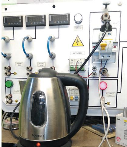
**Рисунок 8.** Подключение нагрузки к УЗДП для испытания
