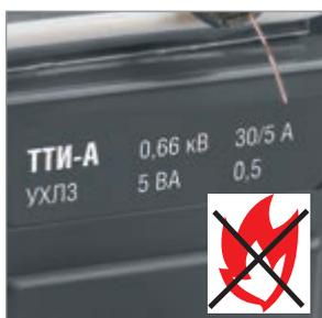
Корпус трансформатора сделан из самозатухающего пластика, что обеспечивает пожаро- и электробезопасность.
