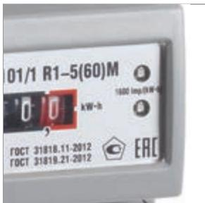
Счётчики в исполнении Ш2 (с двумя шунтами) имеют дополнительный светодиодный индикатор на лицевой панели, информирующий о неравенстве токов в нулевом и фазном проводниках, что даёт возможность пресечь потребление неучтённой электроэнергии без использования сетевого провода N.
