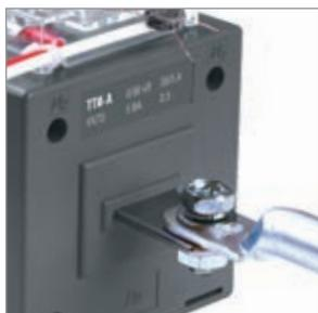
Встроенная медная луженая шина у модификации ТТИ-А дает возможность подключения как медных, так и алюминиевых проводников. Трансформаторы ТТИ-А комплектуются винтами и гайками для крепления проводников.
