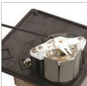
Металлический экран защищает электромагнитную систему от внешних магнитных полей.
